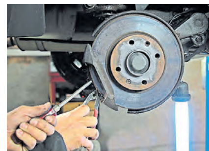
Eine Sichtprüfung der Bremsanlage kann frühzeitig Verschleiß erkennen lassen. Foto: Pixabay
