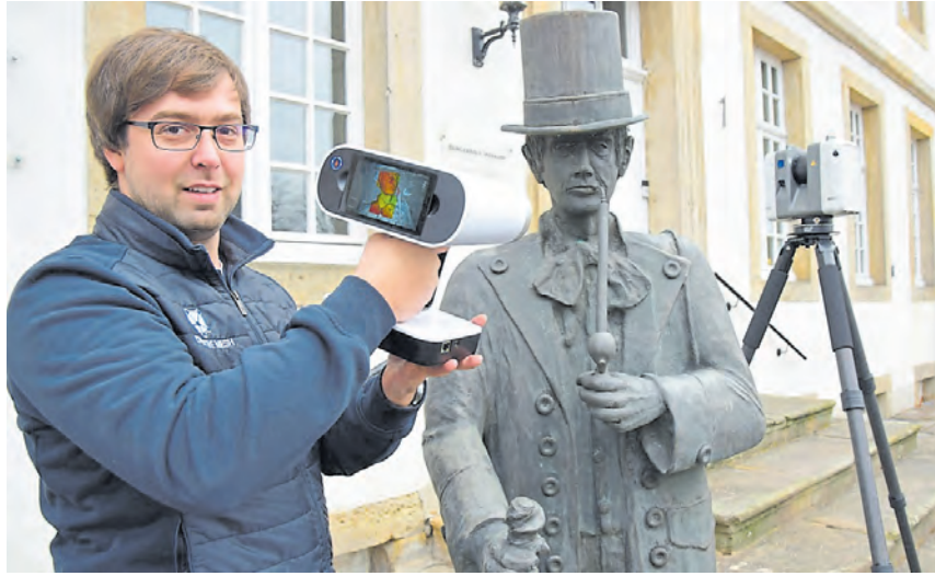
3D-Scanner im Einsatz: Frederic Leifeling erfasst mit dem Handgerät Artec Leo Stück für Stück hochauflösend den Tödden von Hopsten. Im Hintergrund ist der 3D-Laserscanner Artec Ray II für die großen Objekte aufgestellt.
